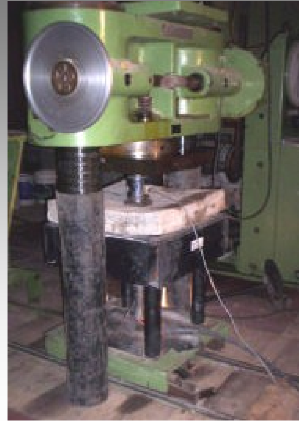
Placa deformada bajo carga
